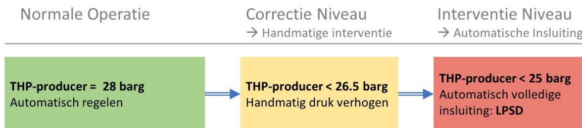
Figuur 4 - Beheersmaatregelen ter voorkoming van pore collapse
